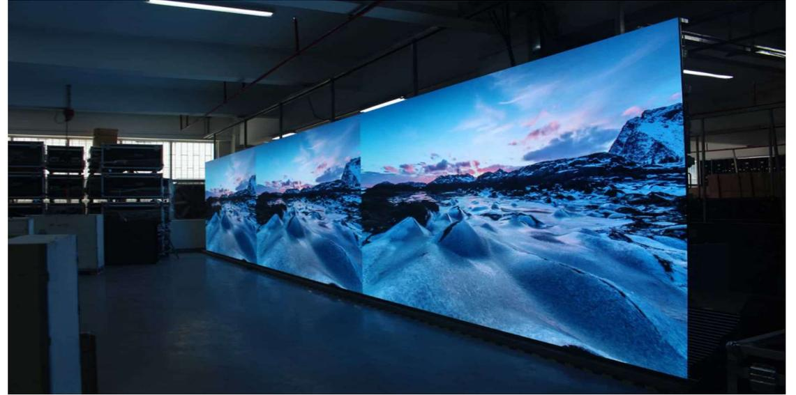
"4 in 1" パッケージング方式の採用により、小ピッチ LED が損傷しやすいという課題をクリアしています。
